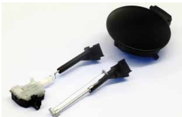
Bild 2: Gewichts- und raumsparende Tankklappenentriegelung mit Formgedächtnisdraht (vorn rechts) im Vergleich zum Elektromotor (links)
